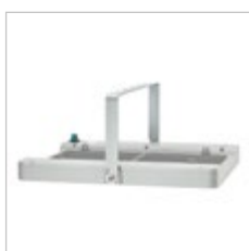
GentleSpace mit Montagebügel (BR): Zur einfachen Montage wird der verstellbare Montagebügel vorab an der Decke befestigt und die Leuchte anschließend eingehängt.
