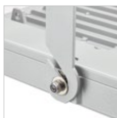
GentleSpace mit Montagebügel (BR): Zur einfachen Montage wird der verstellbare Montagebügel vorab an der Decke befestigt und die Leuchte anschließend eingehängt.
