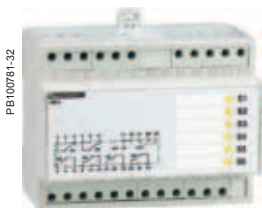
Hilfsschalter M6C: Relais außerhalb des Leistungsschalters mit 6 Wechslern, die unabhängig von dem Leistungsschalter über 3-Draht-Technik gesteuert werden (die maximale Länge beträgt 10 Meter).
