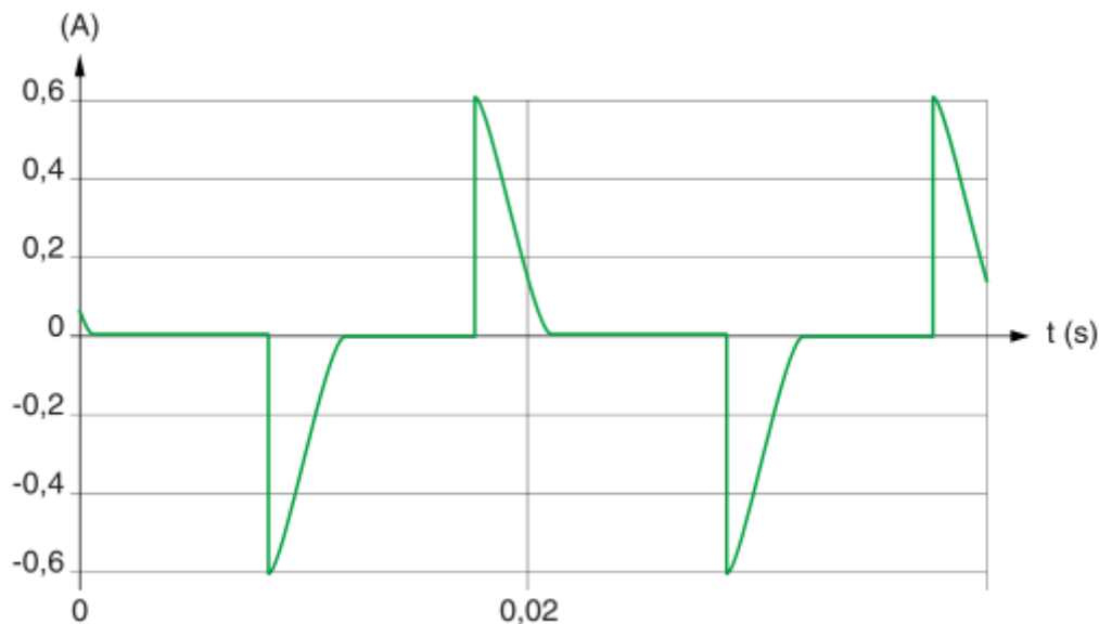
Abb. N46: Form des von einer Kompakt-Leuchtstofflampe aufgenommenen Stroms
