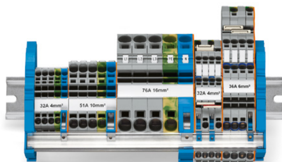
Alle Verteilerklemmen von WAGO passen aufgrund ihrer geringen Bauhöhe problemlos unter die Verteilerabdeckungen gängiger Hersteller.
