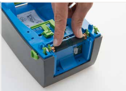
Passende Walze in den Drucker stecken und fixieren.
