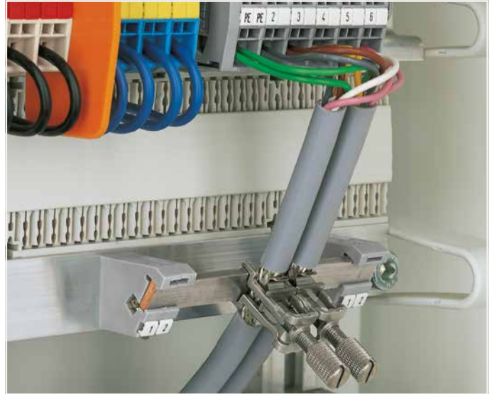
Isolierte Halteblöcke für ein gemeinsames Schirmbezugspotential, unabhängig vom Gehäusepotential
