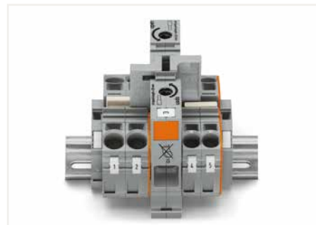
Brücken mit Reduzierbrücken von POWER-CAGE-CLAMP-Klemmen (35 mm²) auf Klemmen TOPJOB® S (10/16 mm²) Serien 2010 und 2016 (gilt jedoch nicht für 2016-76xx und 2016-77xx)
