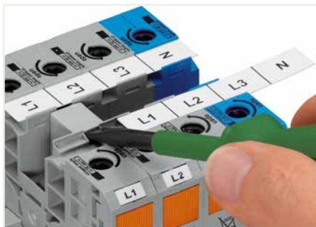
Zum Lösen der Brücken Beschriftungsstreifen seitlich verschieben.
