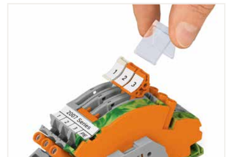
Durch Verwendung von Verriegelungskappen oder -profilen wird eine gleichzeitige Betätigung von Trennhebeln nebeneinander liegender Klemmen vereinfacht.
