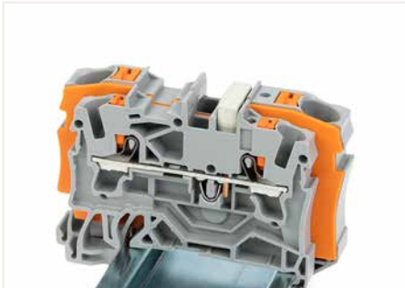
Reduzierbrücker (2006-499): von 6/4 mm 2 (Serien 2206/2204) auf 4/2,5/1,5 mm 2 (Serien 2204/2202/2201)
