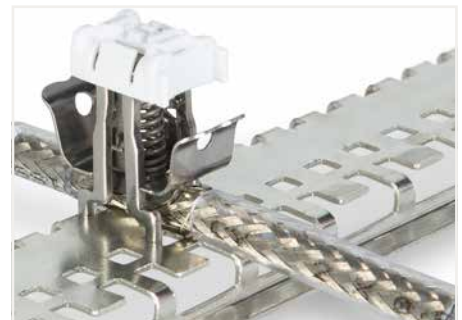
Schirmklemmbügel kontaktiert Schirmleiter und spezialgelochte Tragschiene (790-145).
