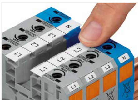
WMB-Beschriftungsschilder oder selbstklebende, bedruckbare Beschriftungstreifen lassen sich an den Hochstromklemmen für 35, 50 und 95 mm 2 aufbringen.
