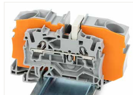
Reduzierbrücker (2016-499): von 16/10 mm² (Serien 2216/2210) auf 10/6/4/2,5 mm² (Serien 2210/2206/2004/2202)
