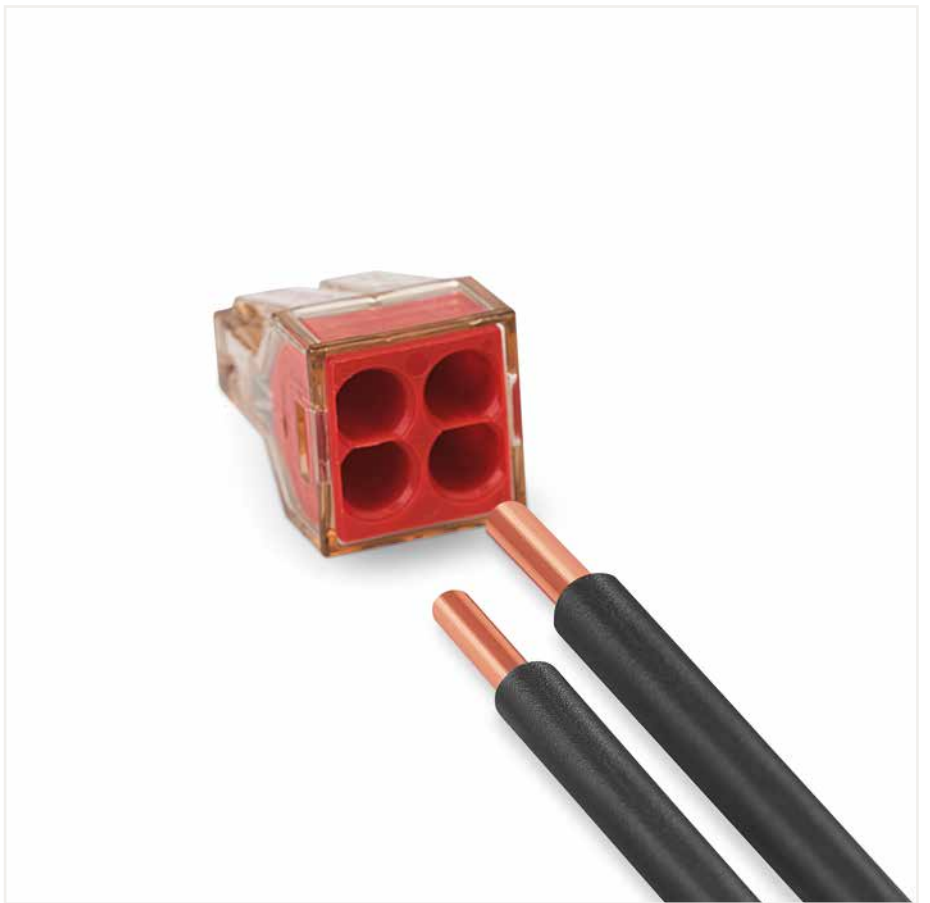
Lösen: Leiter festhalten, Klemme durch Hin- und Herdrehen mit leichtem Zug vom Leiter ziehen.
