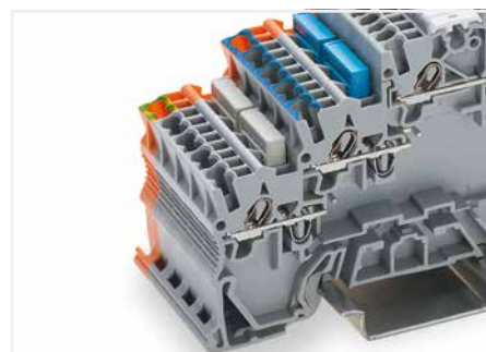
Brücken von PE Bei Initiatoren-/Aktorenklemmen ohne PE-Kontaktierung zur Tragschiene kann die PE-Verbindung über die Brückung zur Klemme mit PE-Fuß erfolgen.
