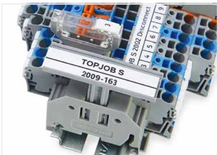
Höhenverstellbarer Gruppenschildträger (2009-163); geeignet für WMB- oder Beschriftungsstreifen (2009-110)
