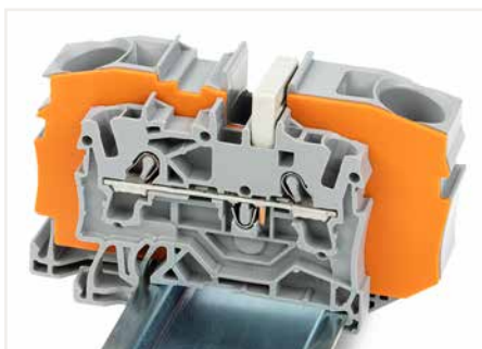
Reduzierbrücker (2016-499): von 16/10 mm 2 (Serien 2016/2010) auf 10/6/4/2,5 mm 2 (Serien 2010/2006/2004/2002)
