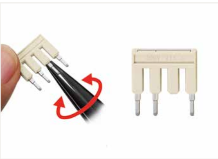
Individuelle Brücker entstehen durch Herausbrechen von Kontaktstiften (Serien 2000, 2001, 2002, 2004).
