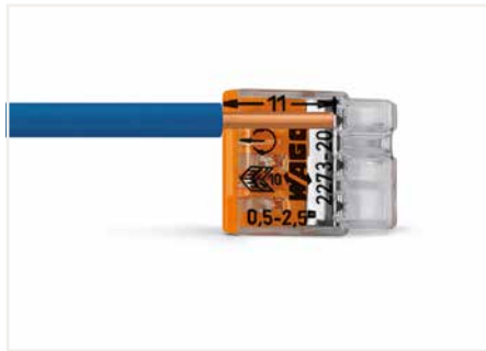
Eindrächtigen Leiter gemäß dem aufgedruckten Maß 11 mm abisolieren.
