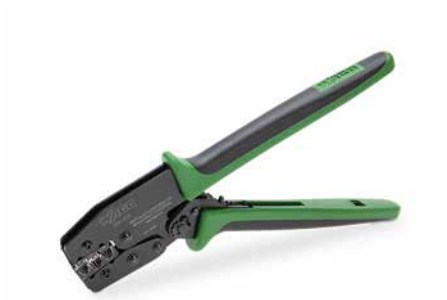
Crimp-Zange 25; für Aderendhülsen mit und ohne Kunststoffkragen; Crimp-Bereich 10 mm 2 , 16 mm 2 und 25 mm 2
