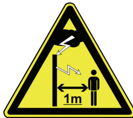
Bild 3 Beispiel für ein Warnschild "Gefahr durch Blitzüberschlag - Abstand 1 m / 3 m einhalten"
