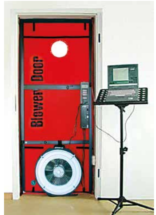
Bild 27: Luftdichtheitsmessung nach der „Blower-Door-Methode“
