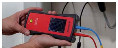
Mit dem „ANALYZER“ Leerlaufspannung und Kurzschlussstrom messen und Strom-/Spannungskennlinie der Anlage ermitteln.
