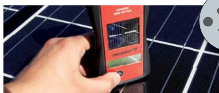
Erneute Messung der Oberflächentemperatur mit dem „SENSOR“.
