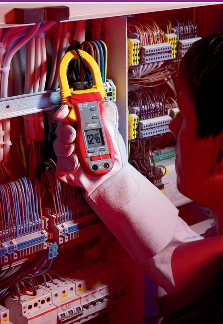
Unsere Strommesszangen und Zangenadapter eignen sich zur Messung von Strömen ohne den Stromfluss unterbrechen zu müssen.
