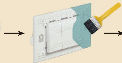
fase de pintura
