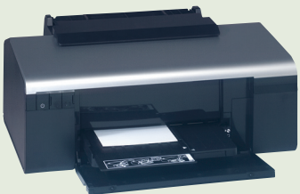
Impressão em marcadores rígidos A impressora vem equipada com um quadro especial de posicionamento (fornecido)
