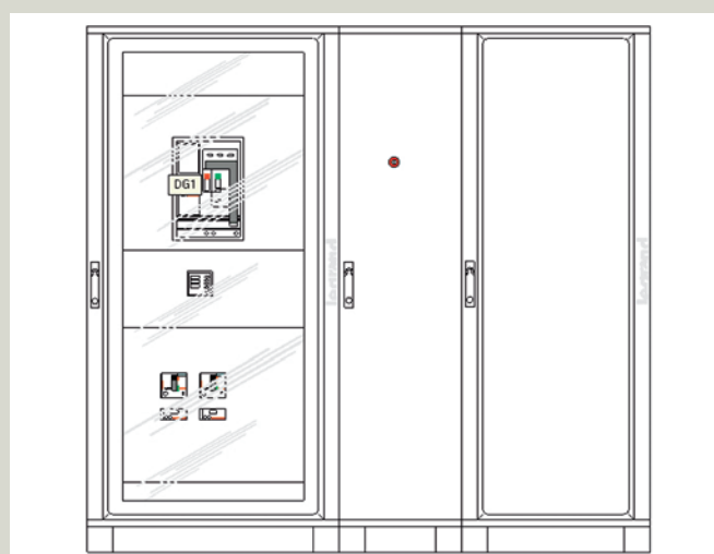
Display do painel completo com portas. O botão de parada de emergência é localizado na porta da cela de cabos
