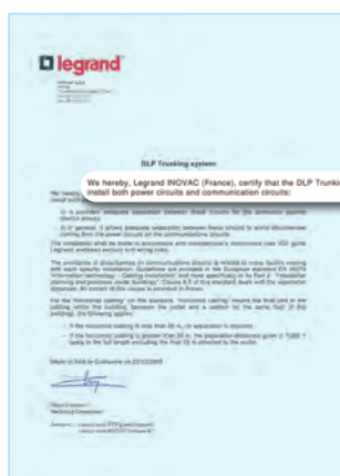
Legrand INOVAC (França), certifica que o Sistema DLP é apropriado para instalações elétricas e de comunicações, numa mesma canaleta com compartimentos separados.
