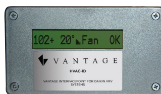
Interface serial de comunicação entre Vantage e HVAC
