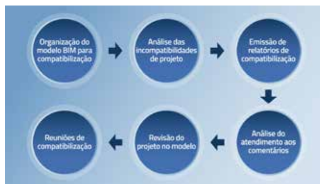
Figura 5 – Etapas do processo de compatibilização. Fonte: Guia ASBEA (2015)
