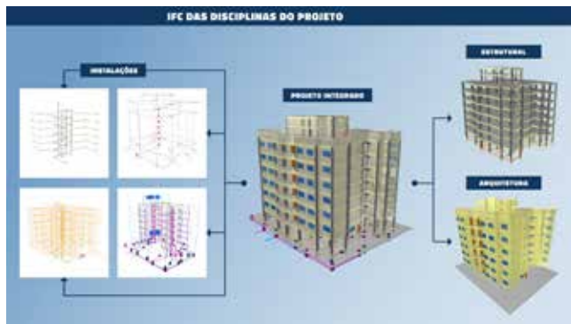
Figura 6 – Modelo de projeto integrado em IFC
