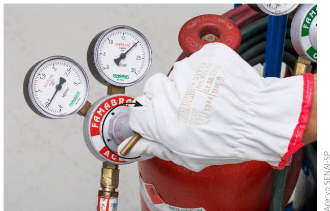
Figura 13 – Regulação da pressão de trabalho do acetileno.
