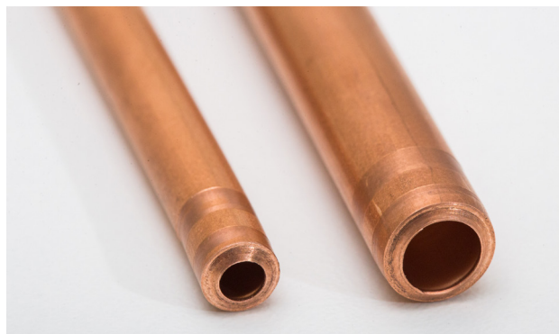
Figura 9 – Exemplo de redução do diâmetro após o corte.
