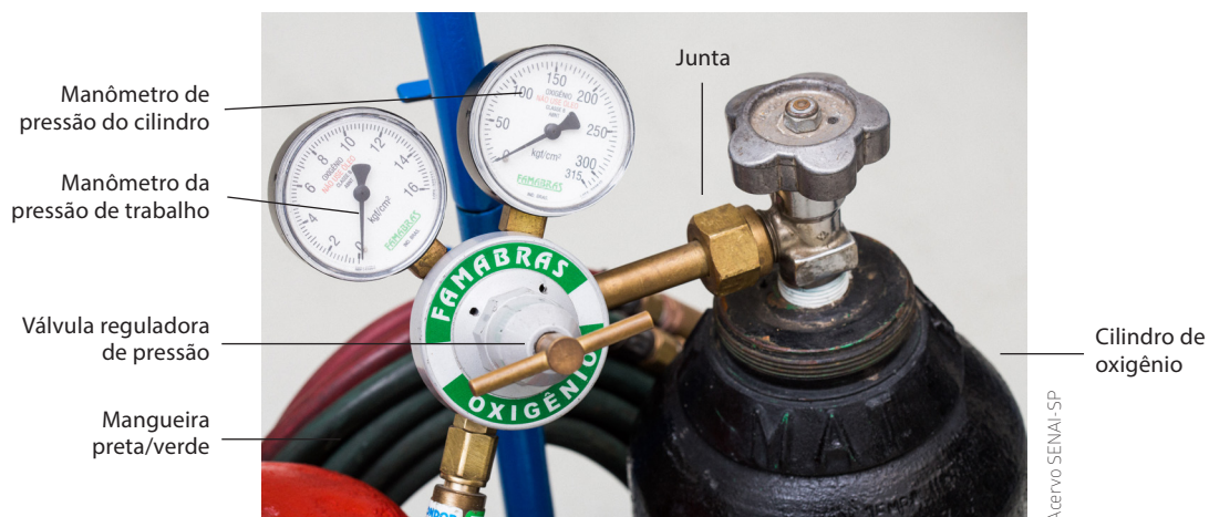
Figura 9 – Componentes do cilindro de oxigênio.
