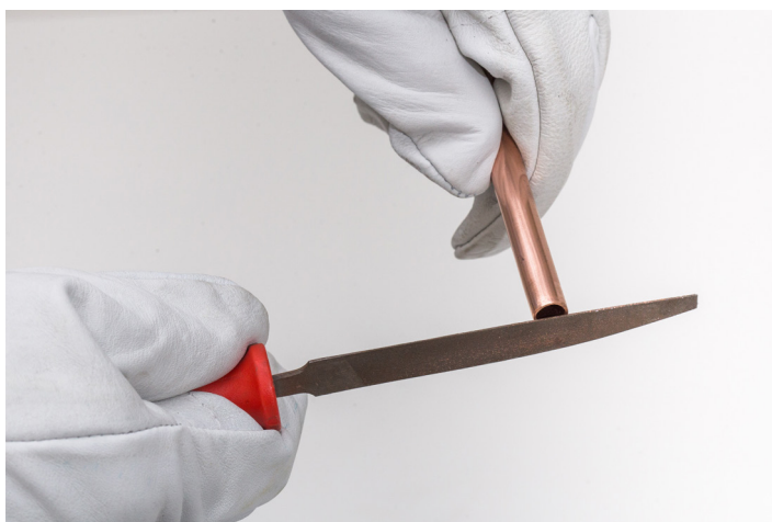
Figura 13 – Exemplo de desbaste da parte do tubo que ficou com espessura menor.
