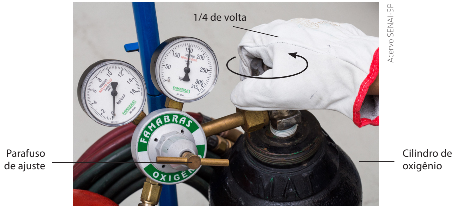
Figura 11 – Abertura do registro no cilindro de oxigênio.
