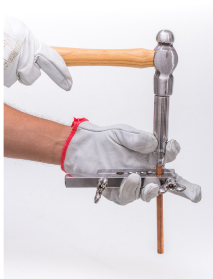
Figura 19 – Exemplo da aplicação do impacto com martelo.
