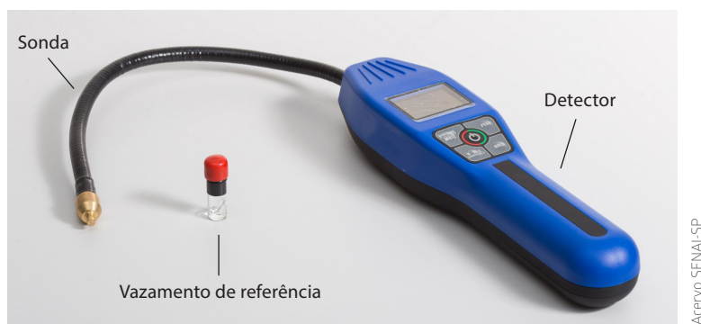
Figura 6 – Detector de hidrogênio e vazamento de referência.
