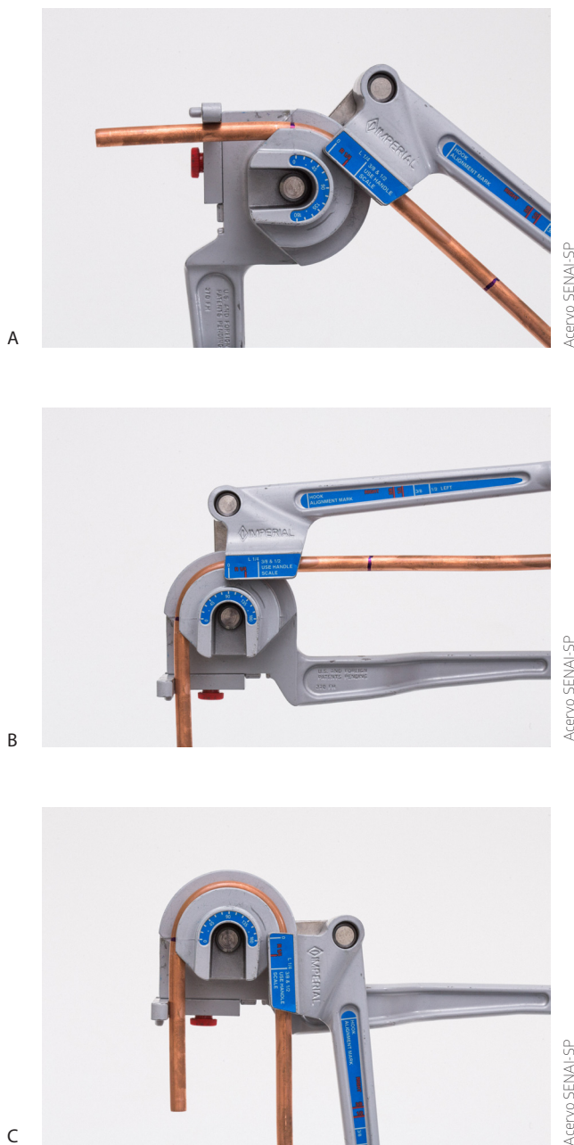
Figura 38 – A a C. Movimento do cabo curvador no sentido do ângulo desejado.
