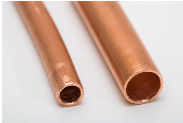
Figura 14 – Exemplo de tubo com a espessura correta após ser escareado e limado.
