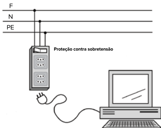
Figura 24 - Proteção contra sobretensão junto do equipamento
