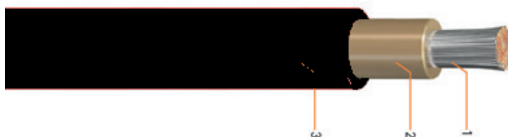
Figura 33 – Construção típica de um cabo fotovoltaico
