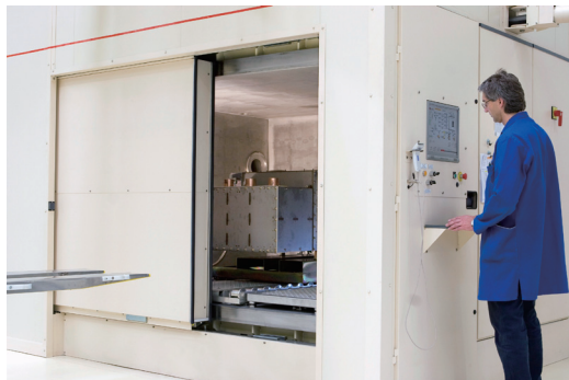
Teste de vazamento – painel de controle do SF6
