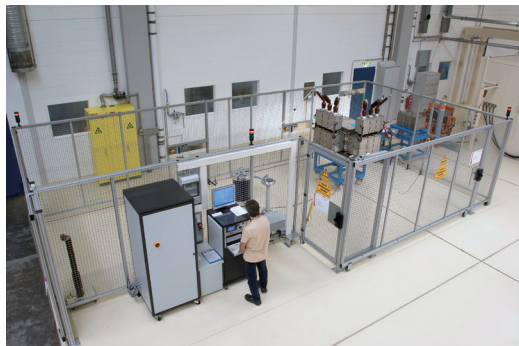
Área de teste para teste de resistência à tensão
