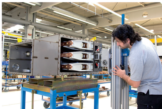
Isolação do disjuntor
