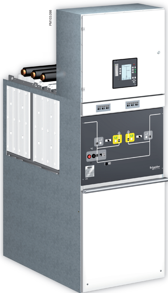
Coluna de interligação de barramento com 1000mm, com aterramento de barramento integrado Ilustração: até 2000 A
