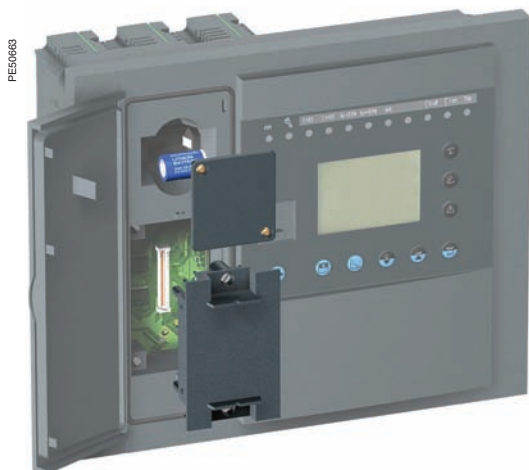
Cartucho de memória e bateria de backup Sepam série 80.
