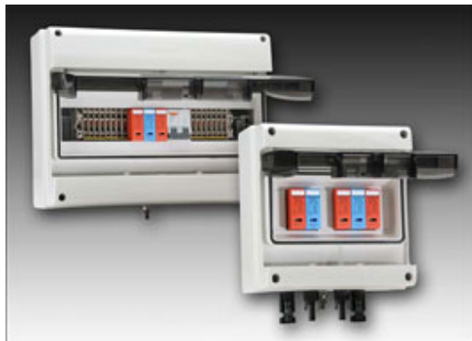
Installationsfertige PV-Lösungen für Solaranlagen. Links: „PV-Box Multistring“ zum Anschließen von bis zu acht Solarstrings. Rechts: „PV-Box AC/DC“ schützt die DC-Seite von einem String und die AC-Seite.
