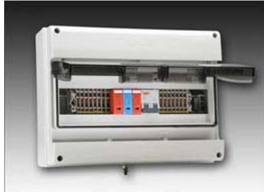
Installationsfertige PV-Lösung für acht Solarstrings. Die Solarpanels sind an den Messtrennklemmen angeschlossen. Diese lassen sich für Messungen einzeln öffnen und schließen.
