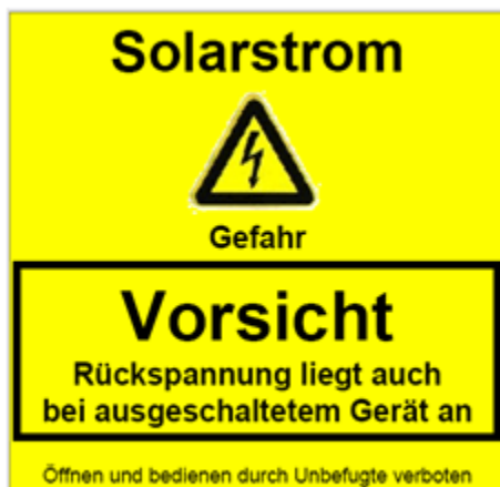
Bild 11: Warnhinweis am Wechselrichter
