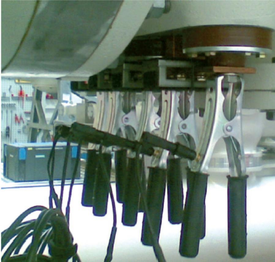
**Bild 9.** Anbringung der Ferrite an einer GIS-Anlage
