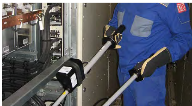
Gleichspannungsprüfer PHE/G II für Gleichstromzwischenkreise (ICE-Triebkopf).
