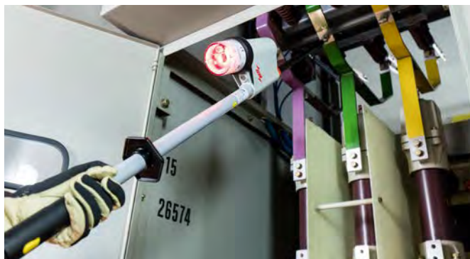
Spannungsprüfer PHE4 mit optischer und akustischer Anzeige.
