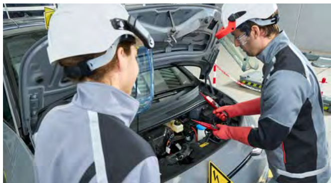
Prüfung der hohen DC-Spannung eines HV-Elektrofahrzeuges.
