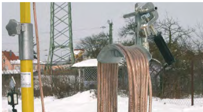
Erdungsspieß mit aufgewickelter Erdungsleitung.
