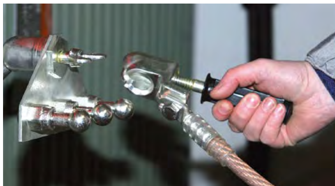
Erdanschlussplatte mit Kugelfestpunkten und Kugelfesthaube mit Handgriff aus Kunststoff.
