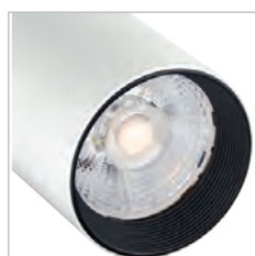
Professionelle Linsenoptik für optimale Farbhomogenität; Reduzierte Blendung (UGR 16 bei 23°; UGR 18 bei 36°) durch schwarzen Blendungsring
