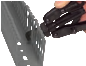
Separación de lastiras con pinza
