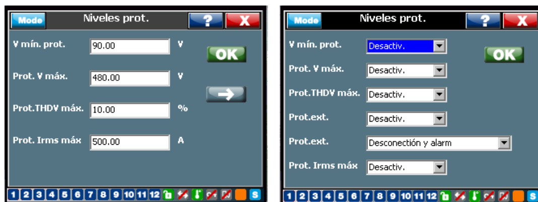
Figura 40: Protecciones del RVT
