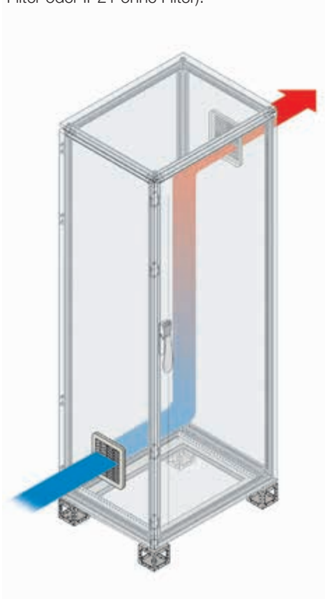
Natürliche Belüftung mit Gittern (IP54 mit Filter oder IP21 ohne Filter).
