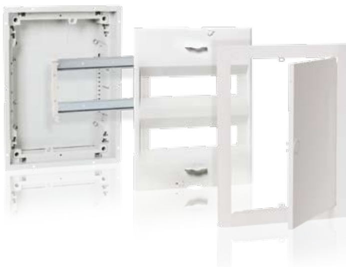
Leichtes Abnehmen von Blendrahmen und Tür, Putzausgleichsmöglichkeit, plombierbare Abdeckung mit 90° Schnellverschluss
