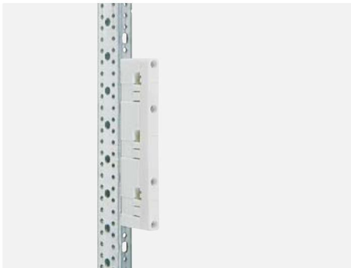
Die Halter werden ohne zusätzliche Bauteile direkt auf das EDF- oder WR-Profil montiert. Einfache Erweiterung auf ein 4- oder 5-poliges Sammelschienensystem durch Anreihung der 1-poligen Halter.
