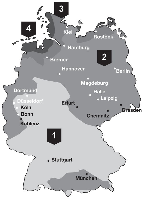
Bild 1: Windzonen in Deutschland nach DIN EN 1991-1-4 NA
