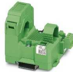
für sinus- und nicht sinusförmige Wechselströme bis 0 ... 200 A, mit Spannungsausgang (...-U), mit Stromausgang, loop powered (...-I-LP)
