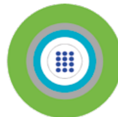
E25, UCFIBRE™ universelles Zentraladernkabel, B2 ca , metallfrei, gelgefüllt
