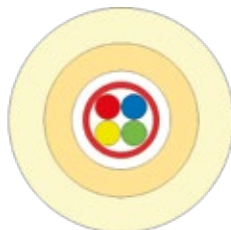
FTTH Indoor Dropkabel mit 2, 4 und 8 Fasern, CPR-Klasse B2 ca
