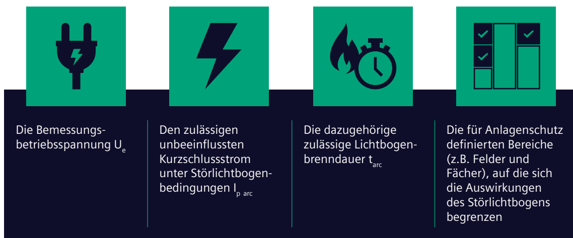
Abbildung 1: Kenndaten für die Prüfung von Schaltgerätekombinationen
