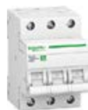
Leitungsschutzschalter, 6 kA, 3-polig IEC/EN 60898-1 Breite (TE): 3
