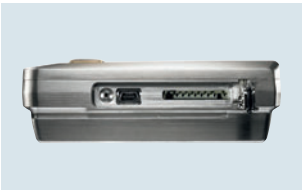
Seitlicher Anschluss von Mini-USB-Kabel und SD-Karte
