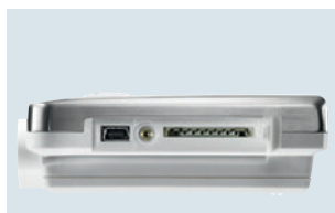
Seitlicher Anschluss von Mini-USB-Kabel und SD-Karte
