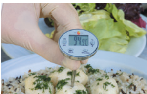
Für Temperaturstichproben-Messungen in der Lebensmittelproduktion.
