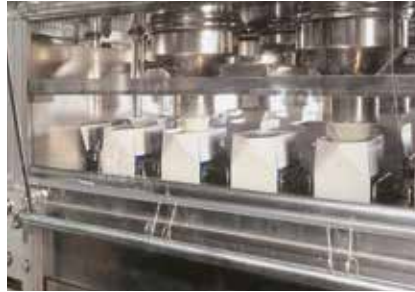
Überdruck im Füllraum hält die Hygiene-Bedingungen bei der Lebensmittel- und Pharmabefüllung aufrecht
