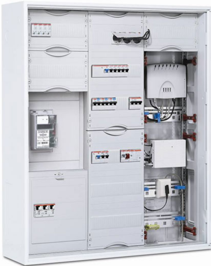
Bild 4: Zählerschrank mit Stromkreisverteiler und Verteilanlage für die Informations- und Kommunikationstechnik für ein Einfamilienhaus (Striebel & John)
