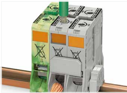
Leiteranschluss – Schritt 2 Abisolierten Leiter bis zum Anschlag in die Klemmstelle führen und in dieser Position halten.
