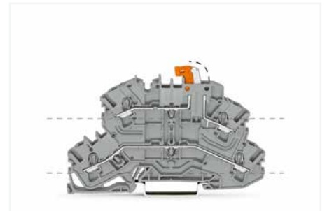
Die Doppelstock-Trennklemme mit schwenkbarem Trennmesser (2002-2671) ist auf der unteren Etage als Durchgangsklemme und auf der oberen als Trennklemme zu verwenden.
