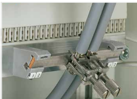
❷ Isolierte Halteblöcke (790-100) für ein gemein- sames Schirmbezugspotential, unabhängig vom Gehäusepotential
