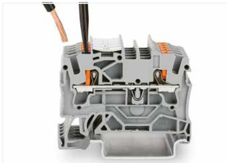
Leiter mit Betätigungswerkzeug anschließen – feindrängige Leiter
