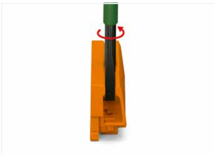
Verrastung mit Betätigungswerkzeug (Klinge 5,5 mm) entriegeln und Klemmschlitten durch Drehen des Werkzeuges auf gewünschte Breite bringen.
