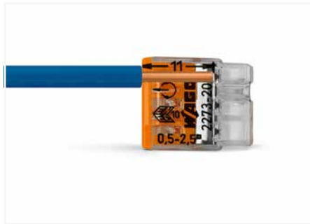
Eindrähtigen Leiter gemäß dem aufgedruckten Maß 11 mm abisolieren.
