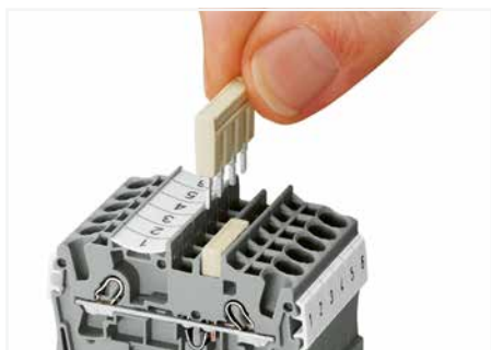
Kammbrücker einsetzen und bis zum Anschlag hinunterdrücken.
