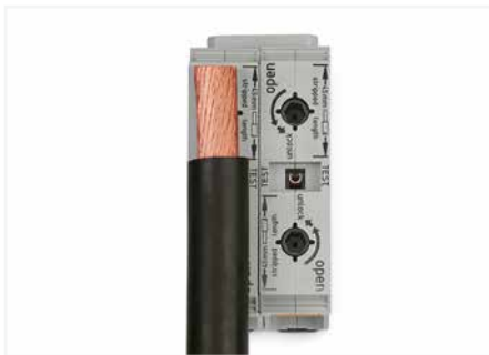
Leiteranschluss – Schritt 2 Abisolierten Leiter bis zum Anschlag in die Klemmstelle führen und in dieser Position halten.
