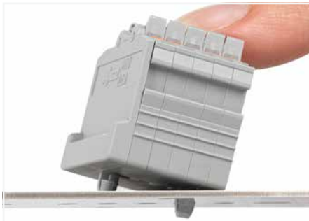
Klemmenleiste mit Rastfüßen in Bohrlöcher einrasten.
