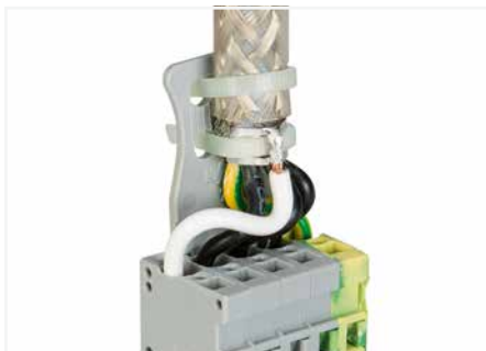
Mittels Kabelbinder den Schirmleiter und die Schirmübergabe (709-350) an der Zugentlastungsplatte befestigen.
