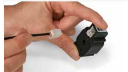
Direktstecktechnik für eindrängige Leiter und feindrängige Leiter mit Aderendhülse
