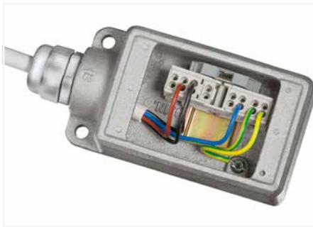
Verdrahtungsbeispiel in einem Ex-Gehäuse
