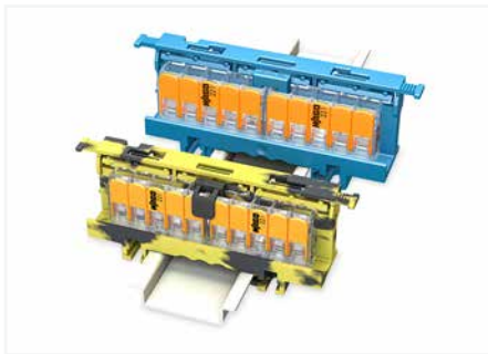
Aufbau von Potentialverteilungen mit bis zu 8 Klemmstellen im Tragschienenadapter, wahlweise mit Verriegelung gegen unbeabsichtigtes Auftrennen der Verbindung (Zuhaltfunktion)
