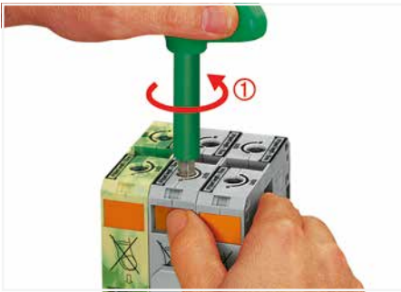
Leiteranschluss – Schritt 1 Innensechskantschlüssel gegen den Uhrzeigersinn bis zum Anschlag drehen ①, dann orangefarbene Taste (Arretierungsfunktion) drücken, Anschlussstelle bleibt geöffnet.
