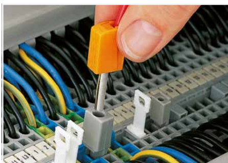
Prüfen mit Bananenstecker Hier über den Prüfadapter (209-170)
