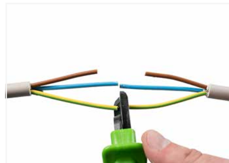
Bei Schadstellen im Kupfer, Schadstelle heraus schneiden und alle weiteren Leiter auftrennen. Bei Schadstellen zwischen 1 mm und 30 mm, müssen mindestens 30 mm der beschädigten Leiter entfernt werden. Tipp: Ein Verbinder (ca. 30 mm lang) kann als Längenorientierung genutzt werden.
