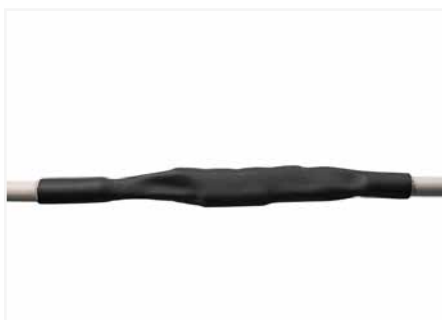
Der Schrumpfvorgang ist erst abgeschlossen, wenn der Schrumpfschlauch eng an der Leitung liegt und der Kleber sichtbar aufgeschmolzen ist. Siehe Foto.
