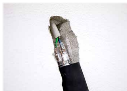
Einsatz mit Schrumpfschlauch.
