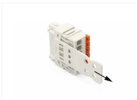
Zugentlastungsplatte in die Aufnahme einführen und bis zum Anschlag in Leiteranschlussrichtung ziehen.
