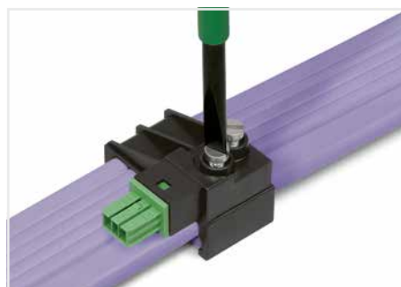
Kontaktieren der Flachleitung durch Anziehen der Schrauben Anzugsdrehmoment von 1 Nm beachten!
