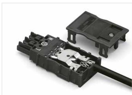
Verdrahteten Steckverbinder in Zugentlastungsgehäuse einlegen, mit Oberteil zusammenfügen und festschrauben.
