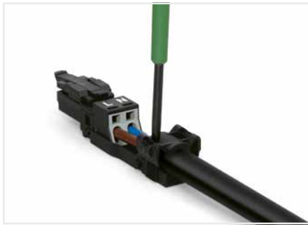
Zugentlastungsschelle mit Schraubendreher (Klingenbreite 2,5 mm) auf beiden Seiten wechselseitig herunterdrücken.
