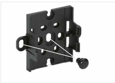
Die Montageplatte kann mittig oder an den beiden äußeren Laschen mit dem Befestigungspin 770-601 befestigt werden.
