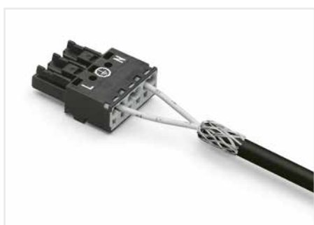
Schirm um Mantelleitung legen. Abmantellänge = 55 mm Schirmlänge = 10 mm
