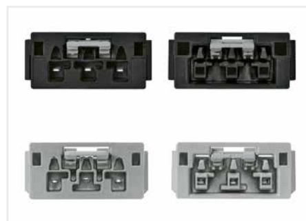
Steckverbinder der Kodierung B (hier in der Farbe Grau dargestellt) unterscheiden sich nicht nur farblich, sondern auch im mechanischen Design und sind somit mit keiner anderen Kodierung steckkompatibel.
