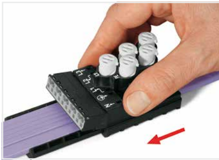
IDC-Modul bündig auf das Unterteil aufschieben. Ist dies durch die blockierende Kodierung nicht möglich, Oberteil um 180° gedreht aufschieben.
