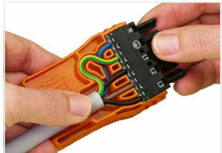
Leiterenden 9 mm abisolieren (siehe Kennzeichnung). Steckverbinder bis zum Anschlag auf die Leiterenden schieben.
