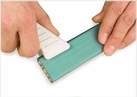
Flachleitungsmantel mit Abisoliermesser an beiden Seiten aufschneiden.
