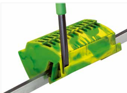
PE-Anschlussblock durch Entriegeln der linken und rechten Blockseite demontieren. Block dann nach oben von der Sammelschiene ziehen.
