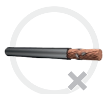
Reste der Leiterisolation auf dem abisolierten Leiter
