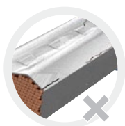
Rissbildung an den Abdrücken des Crimpstempels
