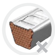
Rissbildung oder Aufplatzen an den Seitenkanten
