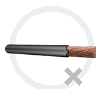
Isolierung nicht einwandfrei eingeschnitten
