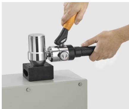
Automatisches Ankörnen an den für die Bohrung vorgesehenen Stellen bei Stempeln für Schwere Steckverbinder.
