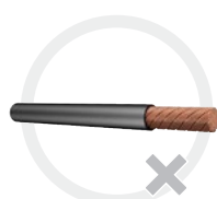
Zu intensiv verdrehte Einzeldrähte
