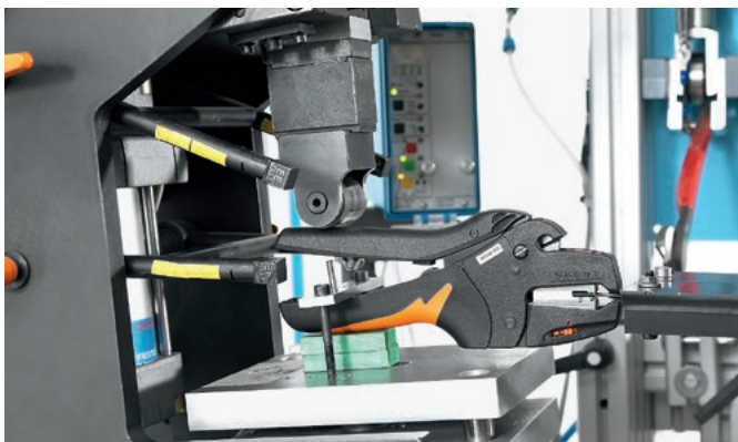
Lebensdauerprüfung der stripax® im Weidmüller Labor
