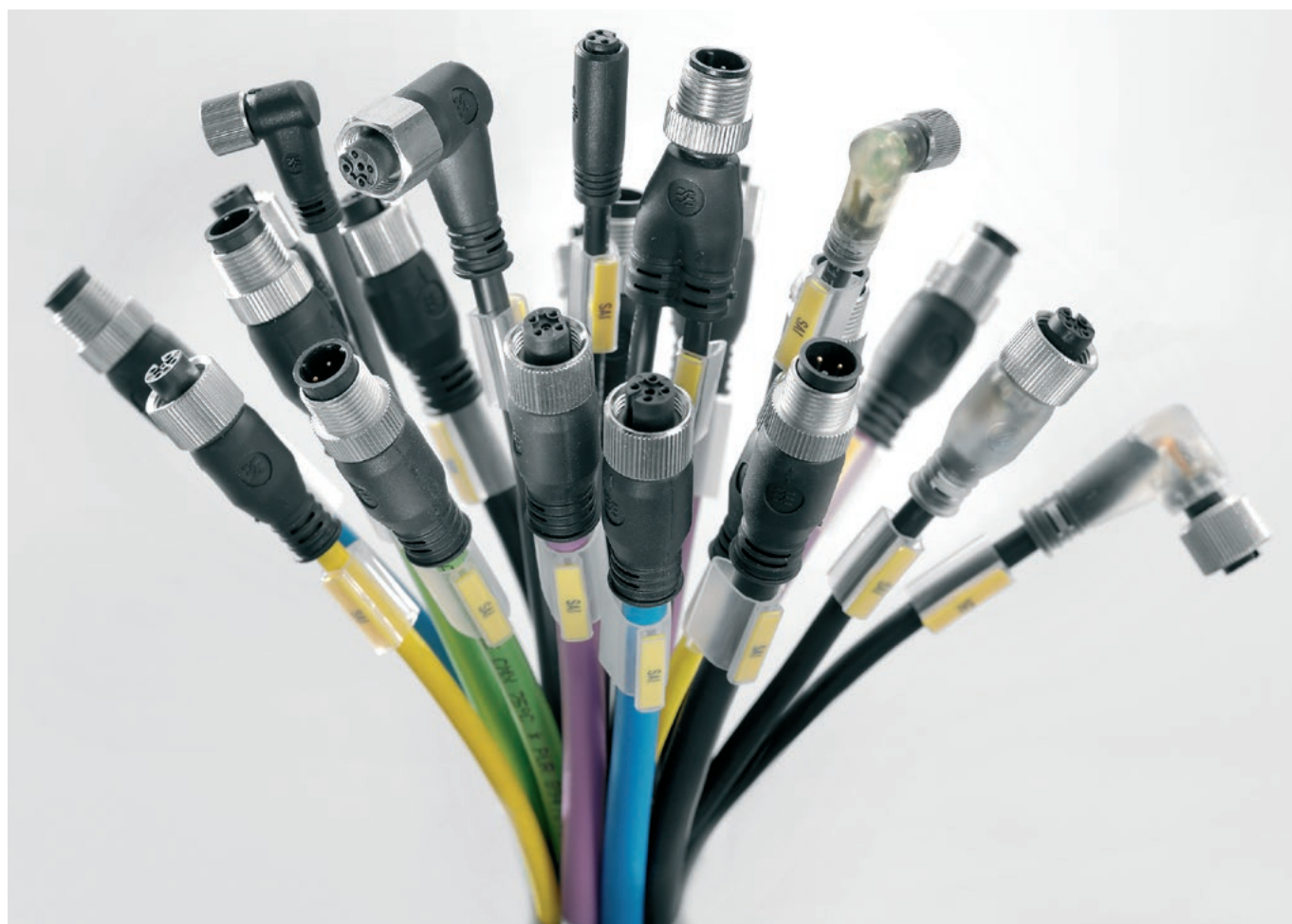
Busleitungen: in diesem Bild in den typischen Farben: blau (Profibus-PA Ex i), schwarz (CANopen/DeviceNet oder Profibus-PA), violett (Profibus-DP) und grün (Industrial Ethernet) zusammen mit Sensorleitungen
