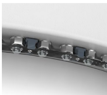
Detektions-Bleche zur Messung und zum Zurückhalten von gerissenen Bolzen am Rotorblattlager
