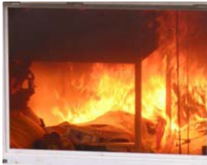
Kinderzimmerbrand nach 3 Minuten:
