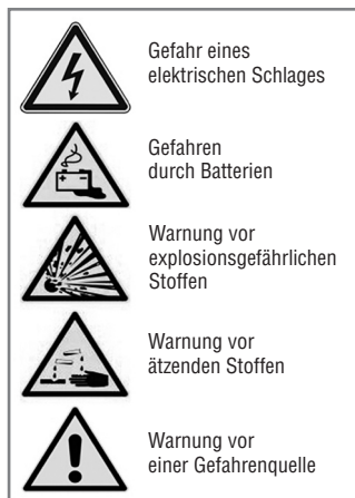
Bild 4: Übliche Sicherheits- und Warnhinweiszeichen bei Batteriespeichern (Auswahl – nicht vollständig)
