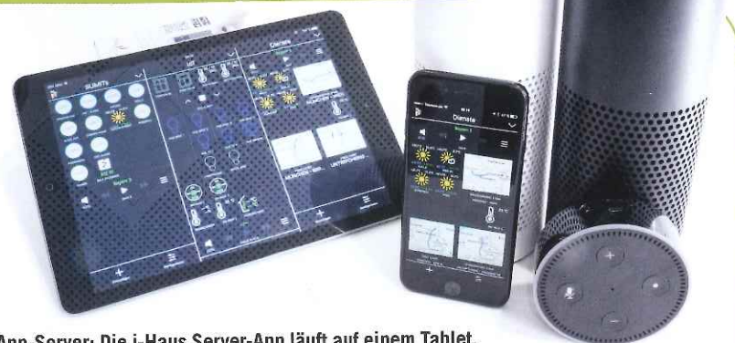
App-Server: Die i-Haus Server-App läuft auf einem Tablet, das im Haus installiert wird. Mit dem Smartphone kann man das System ebenso steuern wie mit Amazon Alexa.
