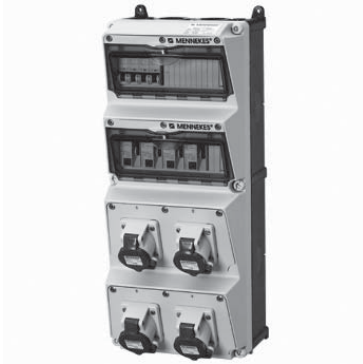
Bild 6.3 Beispiel einer typischen Kombination für Campingplätze: vier Steckdosen, vier Überstrom- und vier Fehlerstromschutzeinrichtungen (RCDs)
